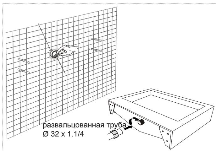
**3\_** Нанести смазку на резиновый фитинг, вставленный в сливную трубу. Установить удлинительную муфту на выпуск раковины и обрезать её до подходящей длины для вставки в трубу.
