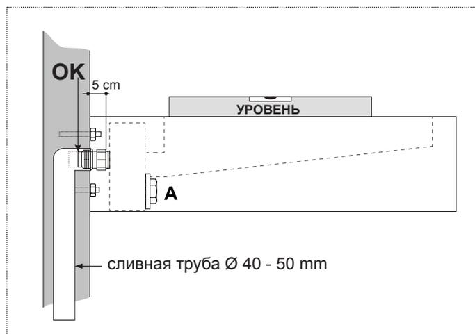
**4\_** После закрепления раковины проверить её работу и герметичность донной пробки сифона.
