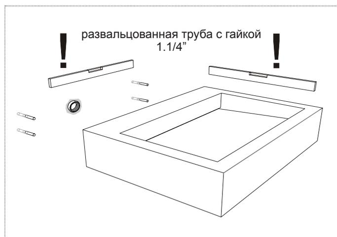
**2\_** Закрепить раковину имеющимися в комплекте винтами, вставить манжету в отверстие канализационной трубы. Просьба не затягивать сильно крепления, чтобы не повредить раковину.
