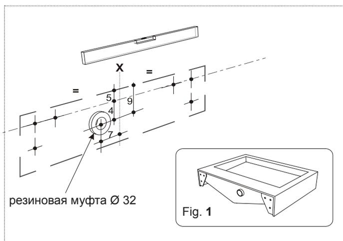
**1\_** Подготовить отверстия для крепления на стене в соответствии с выбранной моделью раковины. Раковины оборудованы встроенными стальными крепежными скобами (рис. 1). Следует тщательно выверить расположение отверстий, чтобы повесить раковину строго горизонтально к полу. **ПРИМЕЧАНИЕ:** Положение слива смещено на 7 см от середины раковины (см. скобу).
