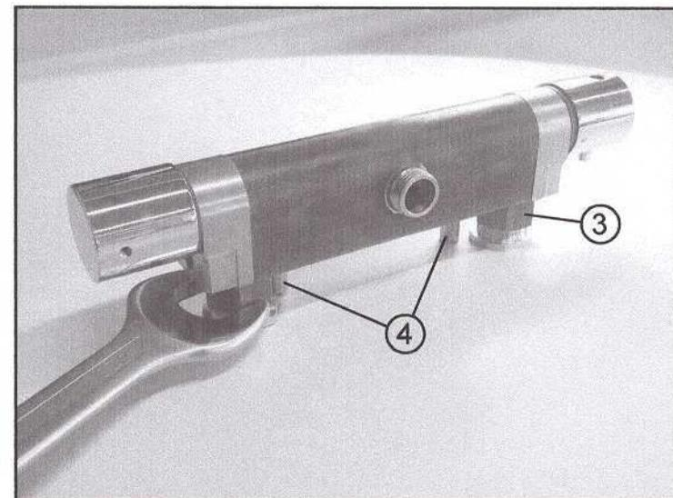
I Regolare gli eccentrici (utilizzando la chiave da 28 mm) fino a trovare l'interasse del corpo rubinetto, appoggiare lo stesso sui raccordi eccentrici e far imboccare i dadi di serraggio 3. Se non si riuscisse ad imboccare entrambi i dadi, imboccarne uno e regolare l'altro eccentrico fino a che si ottiene l'innesto di entrambi i dadi.
