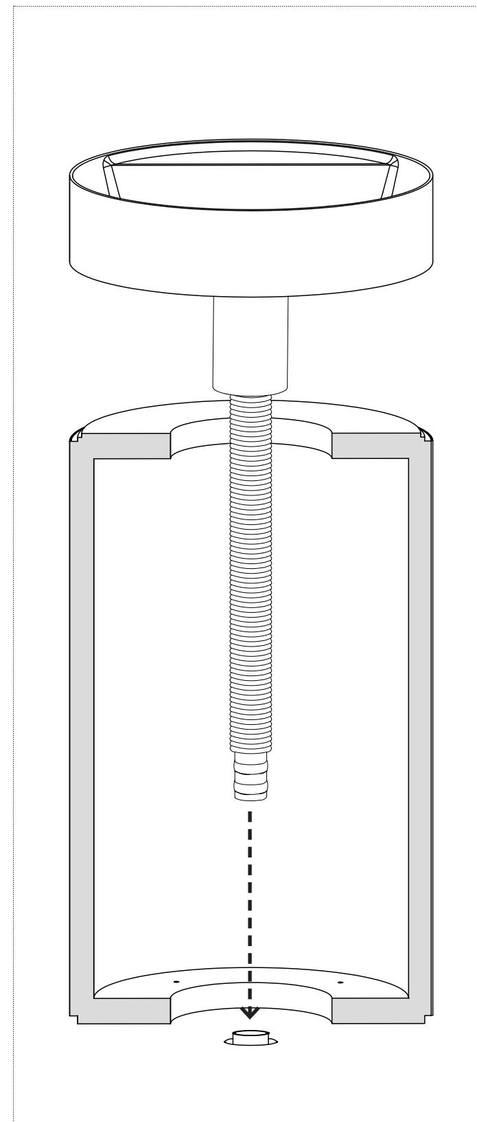
**IT\_4** Collegare il tubo flessibile del lavabo allo scarico a pavimento.
