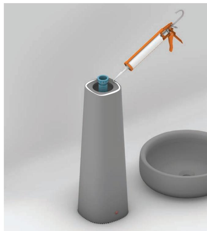
Predisposizione al fissaggio del lavabo alla colonna: stendere un cordone di silicone sul bordo superiore della colonna.
