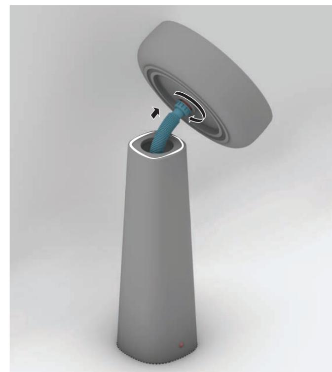
Collegamento del lavabo al sifone: avvitare il tubo di scarico flessibile alla piletta del lavabo.
