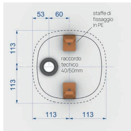
Predisposizione dello scarico a pavimento: utilizzare un raccordo tecnico per lavabo in PP 40/50 mm con morsetto (non in dotazione).
