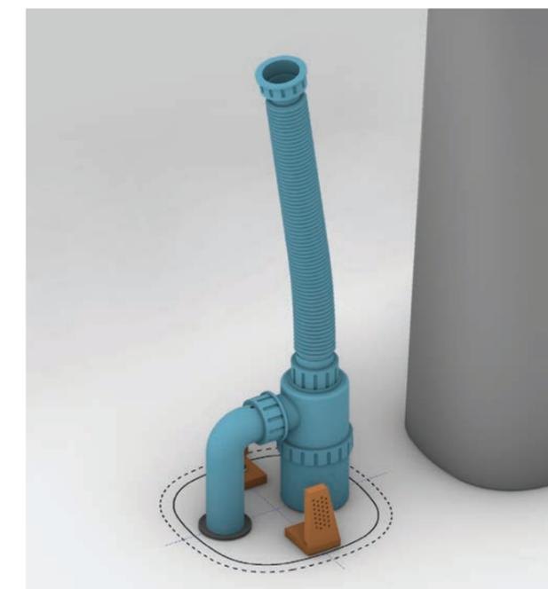
Allestimento del sistema di scarico: collegare il sifone al morsetto.
