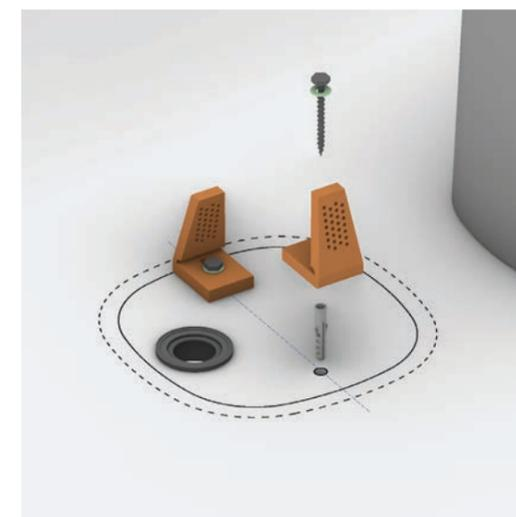
Predisposizione al fissaggio della colonna: tracciare a terra gli allineamenti delle staffe di fissaggio, utilizzando la colonna come dima e le staffe in PE per forare il pavimento.
