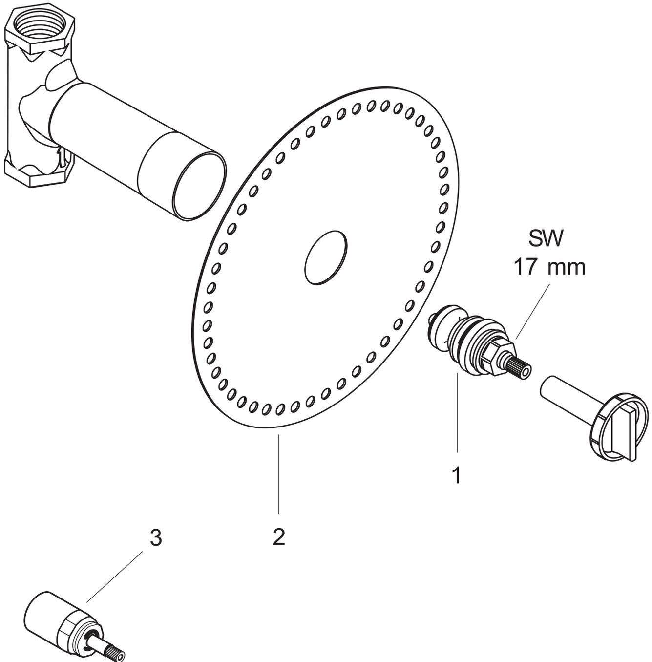
**Скрытая часть запорного вентиля, шпindelная, расход воды 130 л/мин, DN 20**
