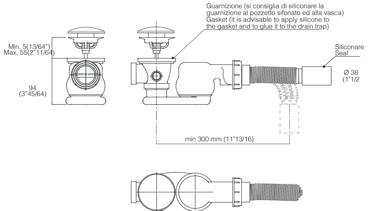
Pozzetto sifonato con raccordo in uscita 1 1/2
