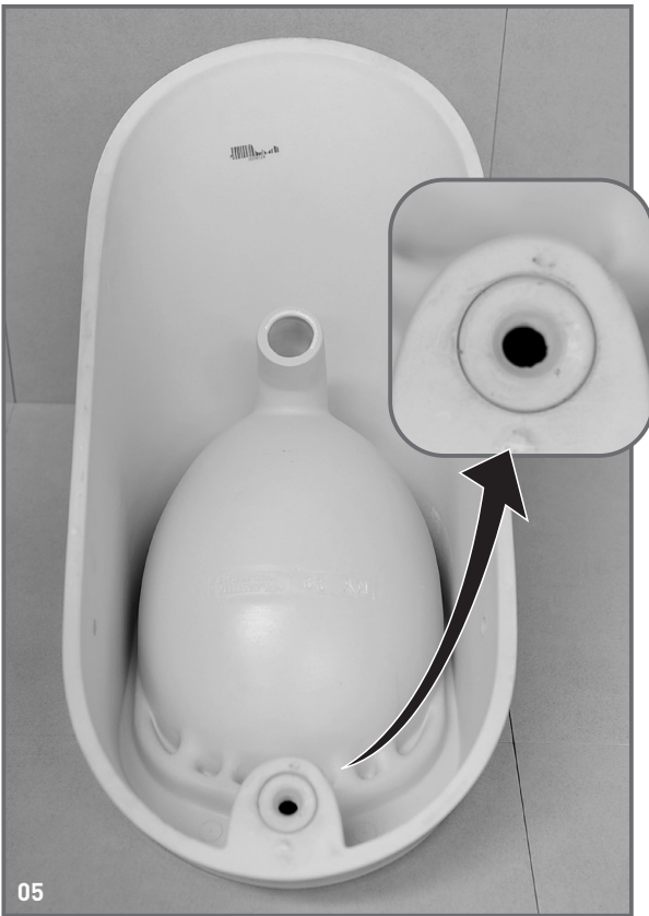
05 Allestimento dell'orinatoio: inserire il morsetto in gomma nell'apposito alloggiamento. Setting up of the urinal: insert the rubber holdfast in the appropriate lodging.
