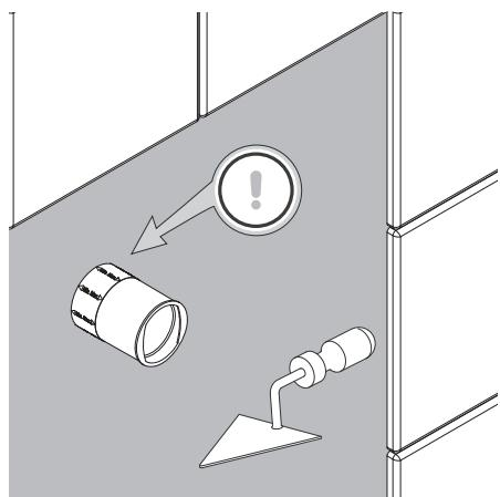
**ITA** - Intonacare la parete facendo attenzione alla dima di riferimento MIN e MAX riportata sulla protezione esterna in plastica per poi proseguire con il rivestimento facendo bene attenzione e cura all'esecuzione dei fori sulle piastrelle che devono essere strettamente aderenti alle coperture in plastica.
