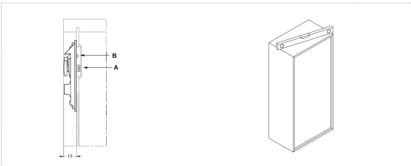
3\_ Разместите мебель по уровню воздействуя на винт **В**, затем прикрепите мебель к стене, затянув винт **А**.
