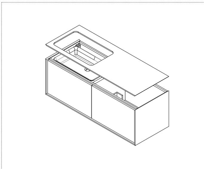
**7\_** Осторожно снимите столешницу, стараясь не сдвинуть раковину. Приступайте к креплению при помощи силикона раковины и столешницы, затем верните столешницу на место.
