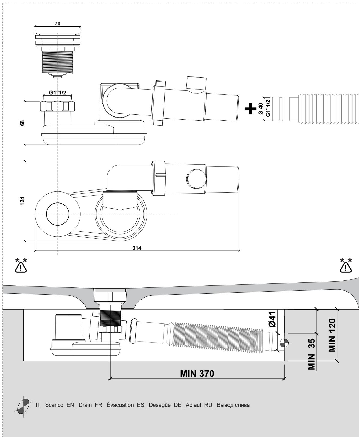
**IT\_3** Dettaglio piletta e sifone. \*\* Per una corretta installazione, prevedere l'uscita dello scarico in relazione alle dimensioni degli articoli in dotazione.
