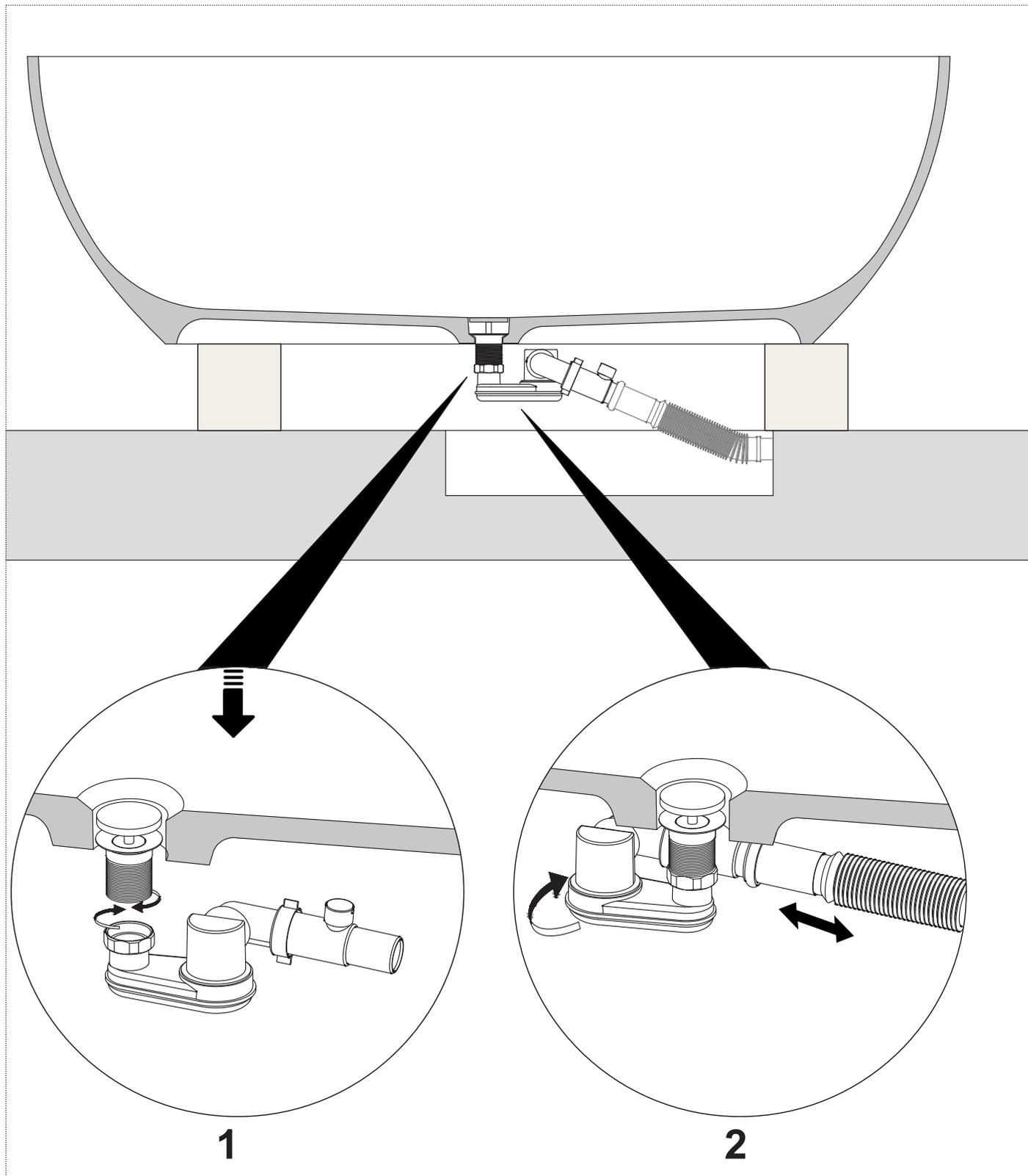
IT\_4\_ Avvitare la piletta (1). Collegare il tubo flessibile al sifone(2), infine inserire l'altra estremità nello scarico predisposto .
