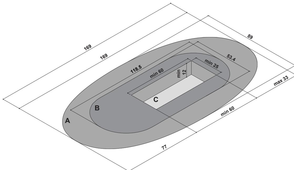
IT\_1\_ A= Ingombro esterno. B= Base d'appoggio. C= Dimensioni pozzetto
