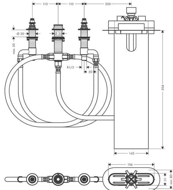
Скрытая часть смесителя на край ванны на 4 отверстия
