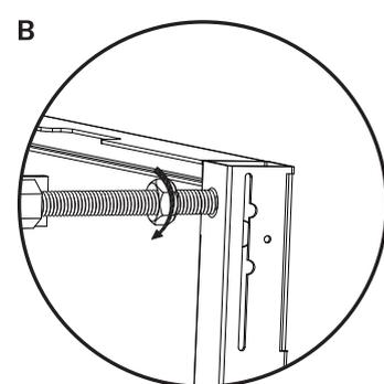
Предварительно затянуть гайку и полностью зафиксировать после точного выравнивания модуля
