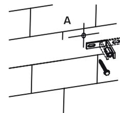
Настенные кронштейны могут быть установлены опорными площадками как внутрь, так и наружу. Соответственно расстояние между отверстиями на стене будет разное.
