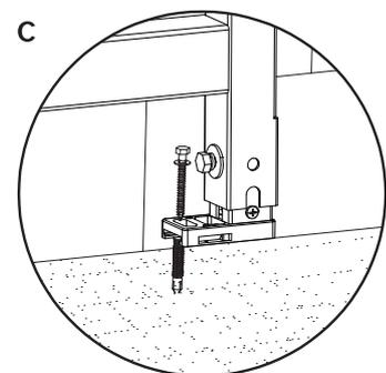
Предварительно затянуть болт и полностью зафиксировать после точного выравнивания модуля
